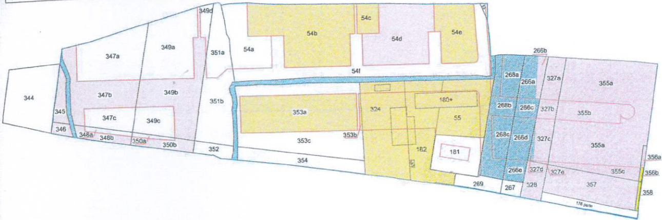
PLANIMETRIA DI PROGETTO CON SOVRAPPOSIZIONE DELLE PROPRIETA' RIDISTRIBUITE ED ESTRATTO MAPPA CATASTALE
